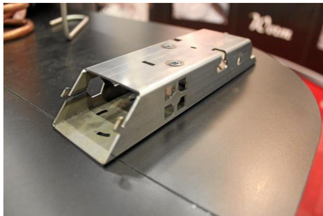
QuickTubes nye TRUMPF laserskærer kan lave flowdrill. Foto/Henrik Eilers.
